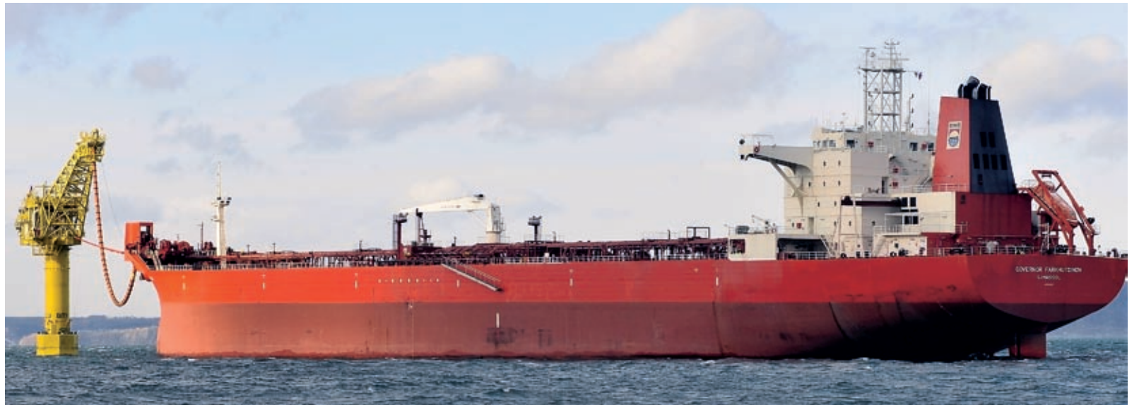
Отгрузка нефти с выносного причального устройства. Фото предоставлено компанией «Сахалин Энерджи»
